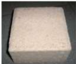
Pavés en béton poreux
