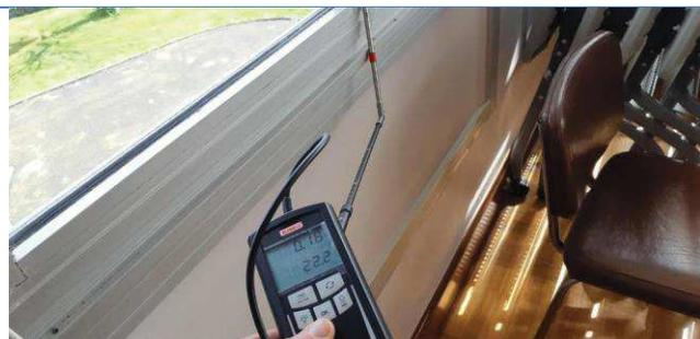
**Type :** C2-Fenêtre et porte fenêtre: Jonction cadres Ouvrant/Dormant (absence ou défaut de compression des joints)
