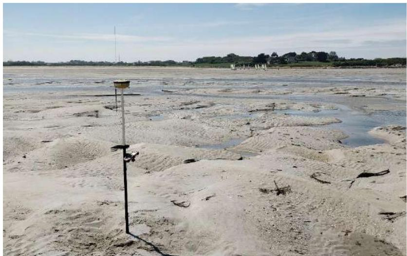
Figure 3 : Appareil de mesure relié au système DGPS, Baie de Goulven (Finistère), 28/05/2021, Quentin Ruaud.
