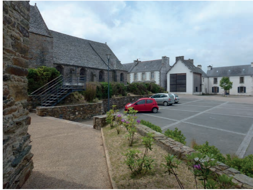
Guimaec (29) aménagement centre-bourg - Alain Le Scour architecte L'espace central est aménagé de façon très sobre avec un carroyage de pavé granit, induisant de façon subtile l'emplacement des véhicules. Ce système engage à limiter la vitesse de circulation et permet de recréer une place fonctionnelle pour tous les usagers, voitures et modes doux.
