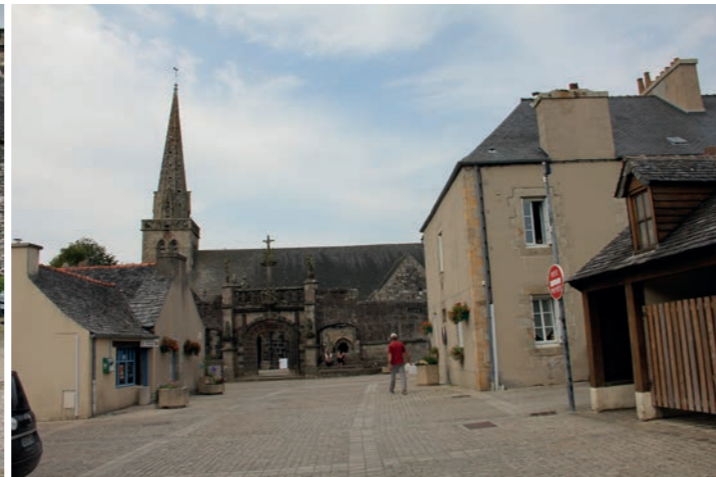
La Martyre (29) - La circulation des véhicules (dalles de béton désactivé) est de plain pied, les espaces piétonniers et de stationnements sont réalisés en pavés de granit.
