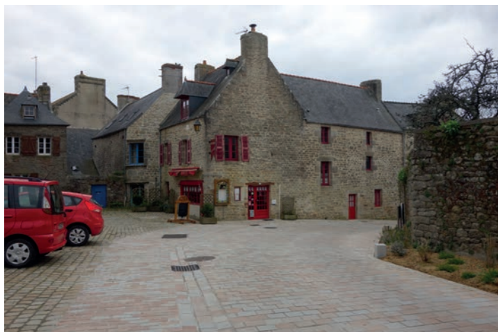
Pont-Croix (29) - La circulation des véhicules, les espaces piétonniers et de stationnement sont réalisés en pavés de granit au même niveau. Seule la mise en œuvre permet de différencier les espaces : sens de poses des pavés, joints enherbés pour les stationnements. Revitalisation du centre-bourg - PLOUGUERNEAU
