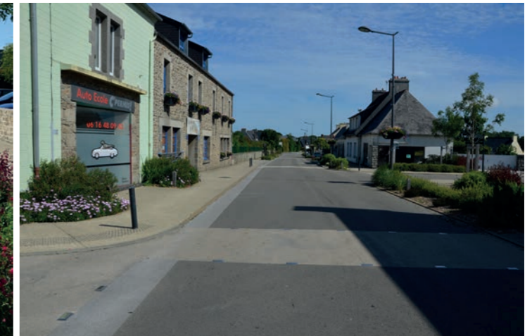
Ploudaniel (29) - La chaussée est réalisée en bitume de couleur grise et beige pour les passages piétons. Les stationnements, en continuité sont réalisés en pavés de granit gris et les trottoirs en béton désactivé.
