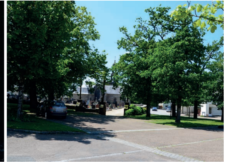
Saint-Divy (29) - Sur un grand espace partagé, les fonctions se côtoient : circulation, espaces verts, stationnement. La chaussée est en bitume gris, des pavés de granit la sépare des stationnements sur du béton désactivé. Des cheminements en pavés de granit permettent de passer au travers des espaces engazonnés.
