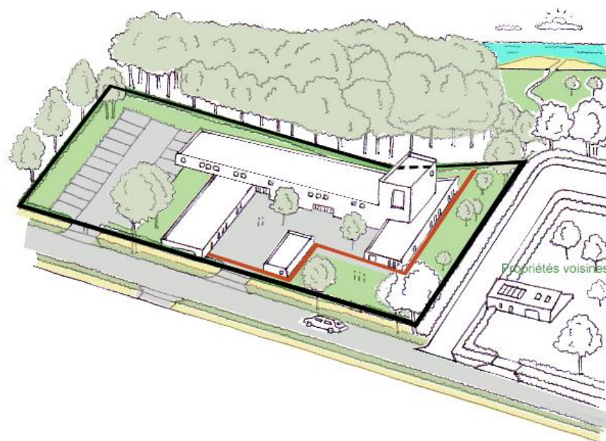
Schéma à titre illustratif : la notion de distance par rapport aux limites
